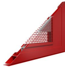
2. v případě požáru šňůra uvolní klapku
